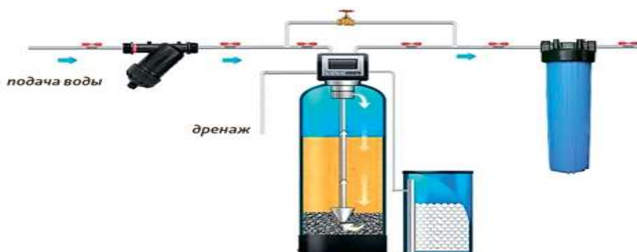
Рис. 3. Схема фильтра-умягчителя циклического действия
