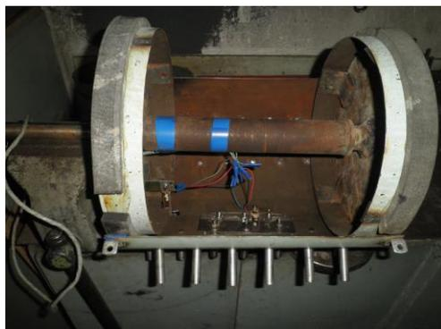
Рис.3. Датчики контроля нагрузки на колки и датчик перемещения обечайки основания колков относительно ступицы.
